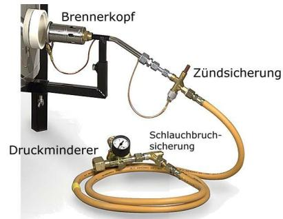
Prüfen Sie immer die Dichtung auf Beschädigung, verwenden Sie keine zusätzlichen Dichtungen. Prüfen Sie weiterhin alle Verbindungsstellen mit einem DVGW-zugelassenen Gasprüfspray auf Dichtigkeit. Wenden Sie sich bei Bedenken auf jeden Fall an Ihren Flaschenhändler.
